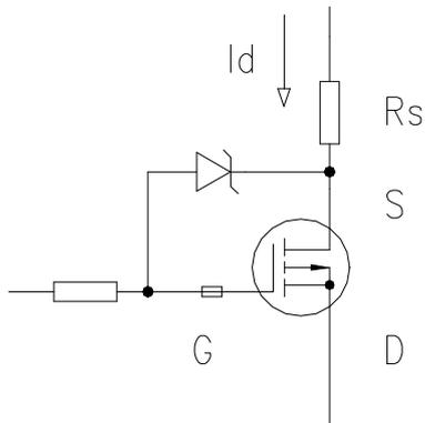
$$V_{gs} = V_{gg} - I_d \cdot R_s$$
