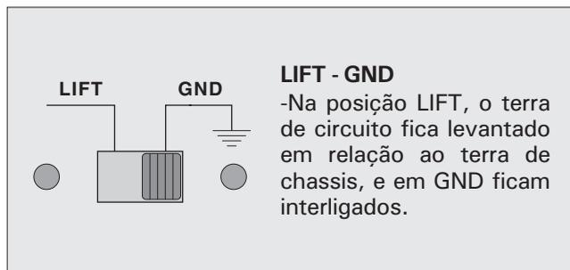
**12 - CHAVE LIFT-GND** - Conecta ou desconecta o terra de circuito do chassi, que fica ligado pelo cabo de alimentação ao terra da rede. Em alguns casos de ruído (Hum), é necessário se desconectar (LIFT) o terra de chassi do de circuito, para evitar um LOOP de terra.
