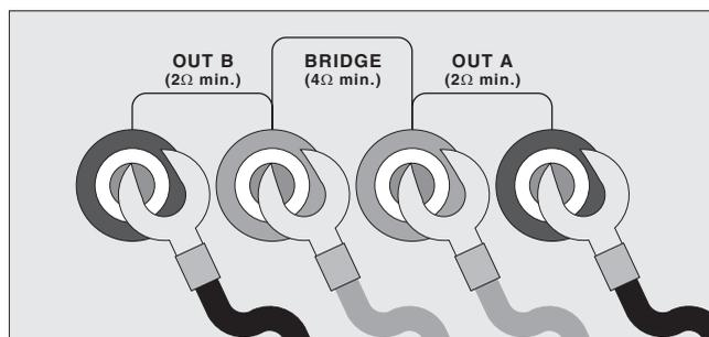
**9 - SAÍDAS P/ ALTO FALANTES** - Estes amplificadores possuem 2 bornes de saída para alto-falantes por canal, 1 vermelho e 1 preto, que servem para ligação com o conjunto de caixas acústicas. **Nunca utilize impedância menor que 2 Ohms para linha 200 e 4 Ohms para linha 800, no conjunto total de alto-falantes.**
