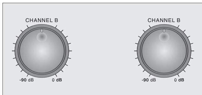
**2 - CONTROLE DE VOLUME** - individual para cada canal. Controla o nível de sinal para cada canal. Na posição -90dB, o nível de sinal é zero e na posição 0 dB, o nível é máximo. É aconselhável que se use o controle de volume na posição 0dB. Nesta posição é necessário 0,775 Volts para excitar totalmente o amplificador.
