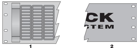
**IMPORTANTE:** A parte frontal do rack deve estar aberta para não obstruir a passagem de ar dos dissipadores. A parte traseira também deve ficar aberta, ou com tela de metal com espuma filtral específica para condicionadores de ar. Esta é recomendada no caso de ambientes com muita incidência de poeira ou umidade. Deixar a frente e traseira do rack afastadas de qualquer anteparo (paredes, móveis, etc), que possam obstruir a passagem de ar.
