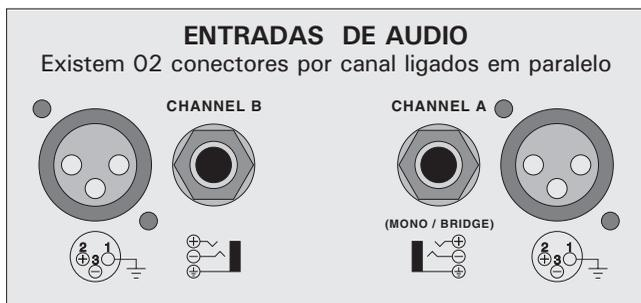
**5 - ENTRADA DE AUDIO XLR** - Uma para cada canal. Estas entradas são balanceadas (1 GND, 2 + hot, 3-cold), ligadas em paralelo com as entradas 1/4 (P-10) de cada canal; isto permite que se faça ligação com outros amplificadores, bastando conectar o cabo de uma mesa ou periférico (crossover, equalizador etc.) a uma das entradas do canal, e conectar a entrada de um outro amplificador a outra que está em paralelo.
