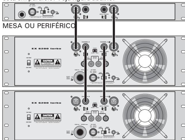
Nesta ligação, a chave seletora da entrada de todos os amplificadores deve estar em STEREO, pois se alguma estiver em MONO, todo o sistema ficara mono. **Nunca ligue dois amplificadores com chave em BRIDGE.**
