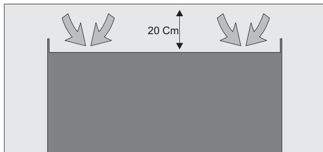
**8 - VENTILAÇÃO** - Entrada de ventilação do painel frontal. Deve ficar totalmente desobstruída e distante de qualquer anteparo no mínimo 20 cm.
