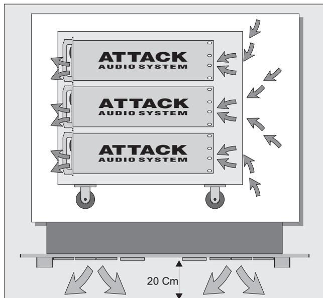
**1 - VENTILAÇÃO** - Saída de ventilação do painel frontal. Deve ficar totalmente desobstruída e distante de qualquer anteparo no mínimo 20 cm.
