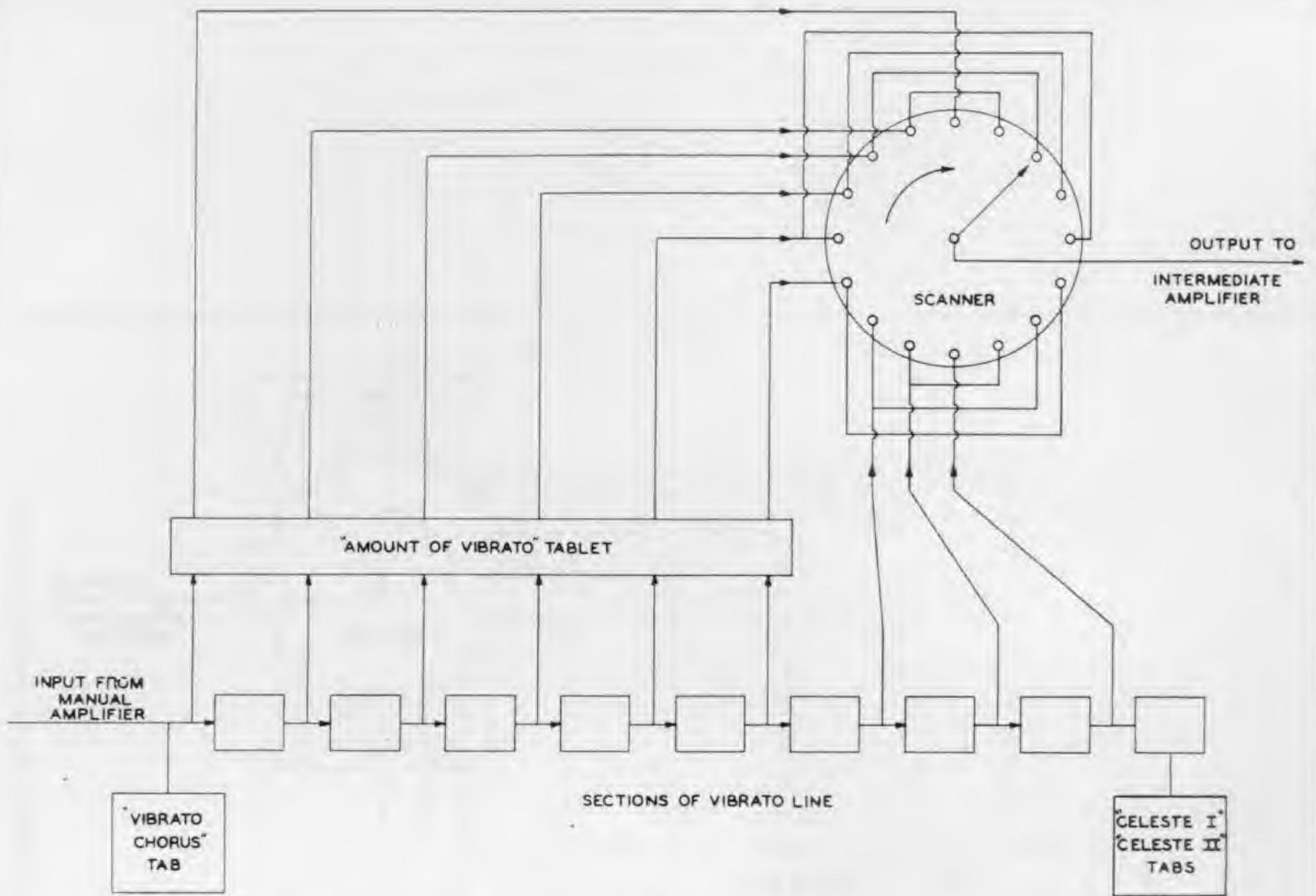
MODEL M-100 FUNDAMENTAL DIAGRAM OF VIBRATO SYSTEM
