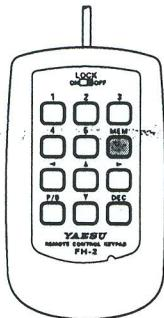
7. Drücken **[MEM]** auf dem LCD berühren oder auf der **FH-2** die Taste **[MEM]** drücken, um den Nachrichtenspeichervorgang zu beenden.
