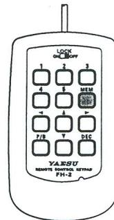
4. Drücken **[CH1]** bis **[CH5]** auf dem LCD berühren oder eine der Tasten der **FH-2** mit den Zahlen **[1]** bis **[5]** drücken, um dieses Speicherregister auszuwählen.
