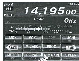
**Im AM-Modus** [**MIC GAIN**] berühren und dann den Regler **MULTI** so einstellen, dass das ALC-Meter bei Sprachspitzen nicht auslenkt.
