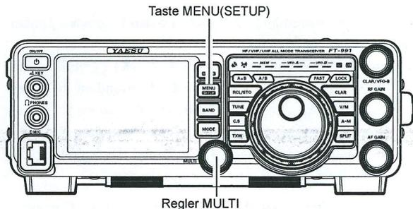
4. Wenn die Einstellung beendet ist, **[ENTER]** auf dem LCD berühren, um die neue Einstellung zu speichern. Dann die Taste **MENU(SETUP)** drücken oder **[BACK]** auf dem LCD berühren, um zum normalen Betrieb zurückzukehren.
