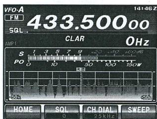
3. Die Taste **UP** oder **DWN** des Mikrofons eine Sekunde lang drücken, oder die Taste **F(M-LIST)** gefolgt von **[SCAN]** drücken, um den Suchlauf in der vorgegebenen Richtung auf der VFO-Frequenz zu starten.
