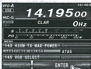
5. Die Taste **MENU(SETUP)** drücken oder **[BACK]** auf dem LCD berühren, um zum normalen Betrieb zurückzukehren.
