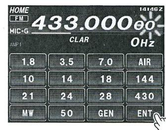
Wenn das Schreiben zum Startkanal abgeschlossen ist, wird die aktualisierte Startkanalfrequenz angezeigt.
