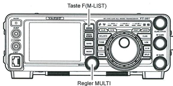
3. Den **MULTI**-Regler drehen, um einen der 15 Algorithmen zu wählen, der den Rauschpegel am besten reduziert.
