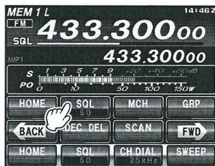
6. Den Hauptabstimmregler etwas drehen (um Speichertuning zu aktivieren). Tuning und Suchlauf sind jetzt auf den Bereich innerhalb der Grenzen von P-1L/P-1U beschränkt, bis die Taste **V/M** erneut gedrückt wird, um zum Speicherkanal- oder VFO-Betrieb zurückzukehren.
