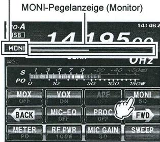
3. Während der Übertragung den Regler **MULTI** drehen, um den Audiopegel im Kopfhörer oder Lautsprecher einzustellen. Drehen dieses Reglers im Uhrzeigersinn erhöht die Lautstärke.
