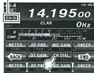
2. Drücken **[CH DIAL]** berühren, um den gewünschten Frequenzschritt auszuwählen. Berühren von **[CH DIAL]** schaltet die Frequenz wie folgt um.
