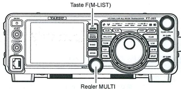
4. Das Senden starten und den Regler **MULTI** drehen, um die „Hang Time“ einzustellen, wie für komfortablen Betrieb bevorzugt.
