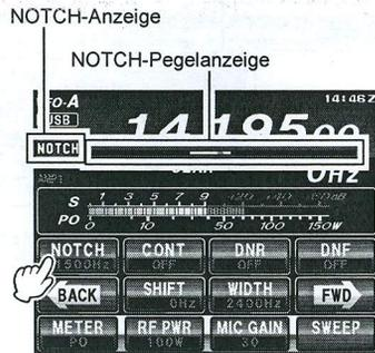
3. Den **MULTI**-Regler drehen, um die „Null“-Position des Notch-Filters einzustellen.
