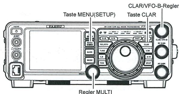
7. Den Regler **CLAR/VFO-B** drehen, um den gewünschten Sender-Offset einzustellen. Eine maximale Teilung von  $\pm 9.999$  kHz kann eingestellt werden.
