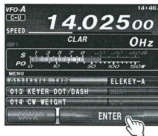
5. Die Taste **MENU(SETUP)** drücken oder **[BACK]** auf dem LCD berühren, um zum normalen Betrieb zurückzukehren.
