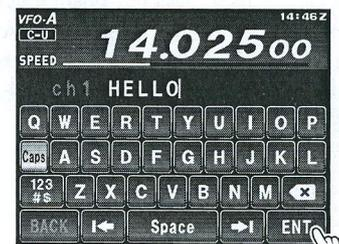
5. Schritt 4 wiederholen, um die restlichen Buchstaben, Ziffern oder Symbole des gewünschten Texts zu programmieren. Zur Erstellung eines Texts können 12 Zeichen verwendet werden. **[←]** und **[→]** auf dem LCD verwenden, um die Cursorposition einzustellen, und **[X]** auf dem LCD verwenden, um einen Buchstaben links vom Cursor zu löschen.
