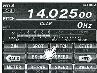
2. Den **MULTI**-Regler drehen, um die PITCH einzustellen (300 Hz bis 1.050 Hz).
