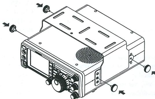
Der Blickwinkel des Funkgeräts kann eingestellt werden, indem die Position der vorderen Befestigungsschrauben geändert wird.
