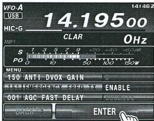
5. Die Taste **MENU(SETUP)** drücken oder **[BACK]** auf dem LCD, um zum normalen Betrieb zurückzukehren. Notkommunikation auf dieser Spotfrequenz ist jetzt möglich.
