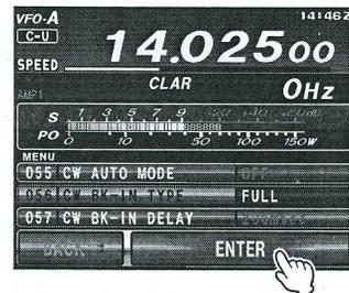
5. Die Taste **MENU(SETUP)** drücken oder **[BACK]** auf dem LCD berühren, um zum normalen Betrieb zurückzukehren.
