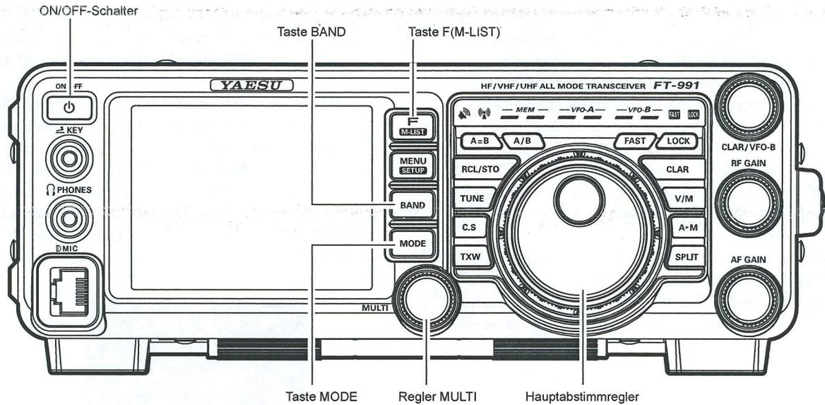
1. Die Taste **BAND** drücken, um die Bandliste zu zeigen, und dann eine Bandtaste, die dem Amateurfunkband, auf dem gearbeitet werden soll, entspricht, berühren. Die Taste **BAND** erneut drücken, um das Bandlistendisplay zu schließen.
