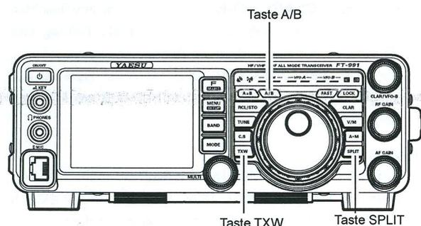
Während des Splitbetriebs wird das VFO-A-Register für den Empfang verwendet, während das VFO-B-Register für das Senden verwendet wird. Wenn die Taste **SPLIT** erneut gedrückt wird, wird der Splitbetrieb aufgehoben.
