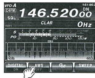
**VW (FR-Modus):** Digitale Sprachdaten werden unter Verwendung der gesamten 12.5-kHz-Bandbreite übertragen. Sprachkommunikation hoher Qualität ist möglich.
