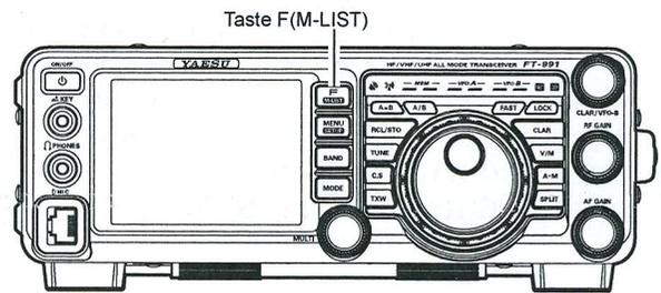
2. Falls gewünscht, kann der Störaustasterpegel über die Menüoption „025 NB LEVEL“ bis zu einem Punkt eingestellt werden, an dem das störende Rauschen vermindert oder beseitigt ist. Zu Details siehe der Rahmen unten.
