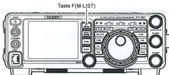
Zum Deaktivieren des digitalen NOTCH-Filters einfach das obige Verfahren wiederholen und dabei **[DNF]** auf dem LCD berühren, um „OFF“ (Aus) zu wählen. Die „DNF“-Anzeige wird ausgeschaltet und bestätigt, dass das digitale NOTCH-Filter nicht aktiv ist.
