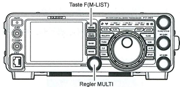
2. Den **MULTI**-Regler nach links oder rechts drehen, um die Störsignale zu reduzieren.
