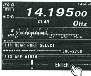
5. Die Taste **MENU(SETUP)** drücken oder **[BACK]** auf dem TFT-Display berühren, um zum normalen Betrieb zurückzukehren.
