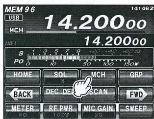
3. Speicherkanäle („5-01“ bis „5-10“) sind werkseitig mit den zulässigen Frequenzen im 5-MHz-Band vorprogrammiert, und die Betriebsart USB oder CW wird auf diesen Kanälen automatisch ausgewählt.
