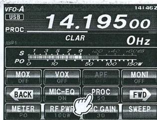
4. Die **PTT**-Taste am Mikrofon drücken, und mit normaler Sprechlautstärke in das Mikrofon sprechen.
