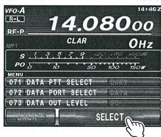
4. Den **MULTI**-Regler drehen, um die Menüoption „060 PC KEYING“ auszuwählen. **[SELECT]** auf dem LCD berühren, dann den **MULTI**-Regler drehen, um diese Menüoption auf „RTS“ oder „DTR“ zu stellen. Die Taste **MENU(SETUP)** drücken oder **[BACK]** auf dem LCD berühren, um zum normalen Betrieb zurückzukehren.
