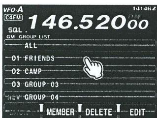
7. **[BACK]** auf dem LCD zweimal berühren. Die GM-Funktion wird ausgeschaltet und die Anzeige kehrt zum vorherigen Display zurück.
