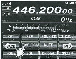
3. Drücken **[TONE/DCS]** auf dem LCD mehrmals berühren, um den gewünschten CTCSS-Modus auszuwählen. Wenn der Repeater einen Uplink-Codierton fordert, „ENC“ auswählen. Für Codier-/Decodierbetrieb von Uplink und Downlink „CTCSS“ wählen. Die verfügbaren Optionen sind:
