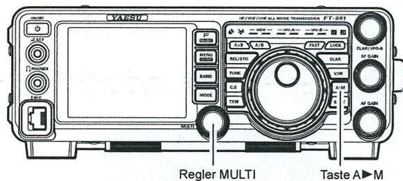
2. Den **MULTI**-Regler drehen, um einen anderen Speicherkanal auszuwählen. Zum Verlassen des Speicherprüfmodus die Taste **A►M** kurz erneut drücken.
