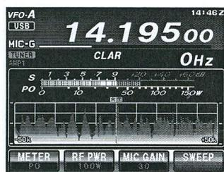
3. Die Taste **TUNE** eine Sekunde lang drücken, um das automatische Tuning zu beginnen. Der Sender wird aktiviert und das „**TUNER**“-Symbol blinkt, während das Tunen stattfindet. Wenn der optimale Tuningpunkt erreicht worden ist, kehrt das Funkgerät zum Empfang zurück und das „**TUNER**“-Symbol leuchtet erneut stetig (statt zu blinken).
