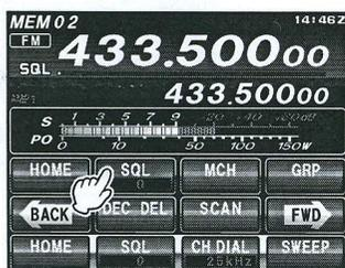
3. Die Taste **UP** oder **DWN** des Mikrofons eine Sekunde lang drücken, oder die Taste **F(M-LIST)** gefolgt von **[SCAN]** drücken, um den Suchlauf in der vorgegebenen Richtung auf der VFO-Frequenz zu starten.
