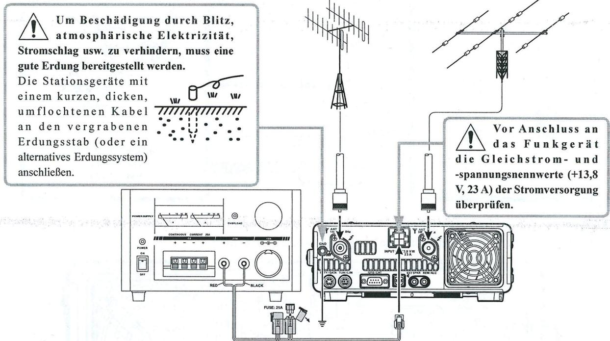
Wir empfehlen, die Wechselstromversorgung **FP-1030A** (nur USA-Markt) zu verwenden. Andere Modelle von Stromversorgungen können mit dem **FT-991** verwendet werden, aber die Eingangsspannung von 13,8 VDC, Strombelastbarkeit 23 A und oben beschriebenen DC-Kabelpolaritätsrichtlinien müssen streng befolgt werden.
