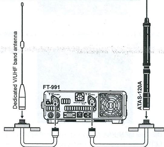
Bei Verwendung eines Antennenduplexers muss der ANT-Anschluss der **ATAS-120A** und der HF/50 MHz ANT-Anschluss des **FT-991** in Reihe geschaltet und ebenfalls von der Erdung isoliert werden, um die Steuerspannung für die **ATAS-120A** zu liefern.
