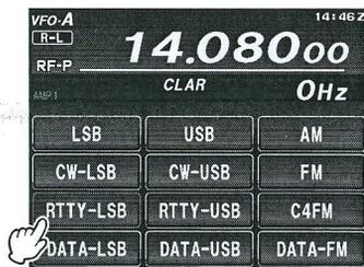
3. Die Taste **MENU(SETUP)** drücken. Die Menülite wird im Display angezeigt. Den **MULTI**-Regler drehen, um die Menüoption „072 DATA PORT SELECT“ auszuwählen. **[SELECT]** auf dem LCD berühren, dann den **MULTI**-Regler drehen, um diese Menüoption auf „USB“ zu stellen. **[ENTER]** auf dem LCD berühren.
