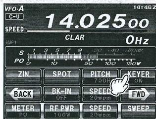
4. Drücken **[SPEED]** auf dem LCD berühren, dann den Regler **MULTI** drehen, um die gewünschte Sendegeschwindigkeit (4 - 60 WPM) auszuwählen.
