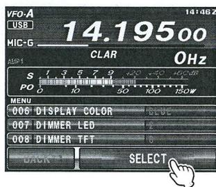
4. Drücken **[ENTER]** auf dem LCD berühren, dann **[BACK]** auf dem LCD berühren oder die Taste **MENU** drücken, um die neue Einstellung zu speichern und zum normalen Betrieb zurückzukehren.
