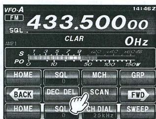
4. Wenn der Scanner bei einem eingehenden Signal anhält, blinkt der Dezimalpunkt zwischen den „MHz“- und „kHz“-Ziffern der Frequenzanzeige.
