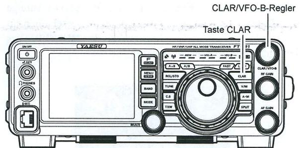
Zum Abbruch des Clarifier-Betriebs die Taste **CLAR** drücken. Die Anzeige „**RX**“ am Display wird ausgeblendet.
