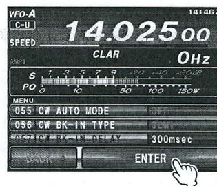
6. Die Taste **MENU(SETUP)** drücken oder **[BACK]** auf dem LCD berühren, um zum normalen Betrieb zurückzukehren.
