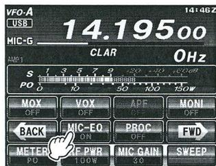
Zur Einstellung des parametrischen Mikrofon-Equalizers, während der Sprachprozessor aktiviert ist, die Taste **F(M-LIST)** drücken, dann **[PROC]** drücken, um „ON“ auszuwählen.
