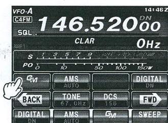
Bis zu 24 Stationen, die mit der GM-Funktion innerhalb der Kommunikationsreichweite arbeiten, werden auf dem TFT-Display angezeigt.
