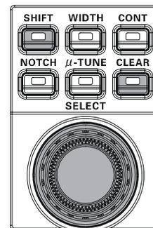
Con l’indice della manopola **[SELECT(SHIFT)]** a puntare le ore 12, riferitevi alla fig. (A), la “sella” del filtro DSP è stretta come una lama. In fig. (B) appare un segnale interferente all’interno della banda passante originaria. In fig. (C) vedete l’effetto della rotazione del comando **[SELECT(SHIFT)]**, spostando la banda passante del filtro, a ridurre il livello dell’interferenza ponendola fuori dalla banda passante.
