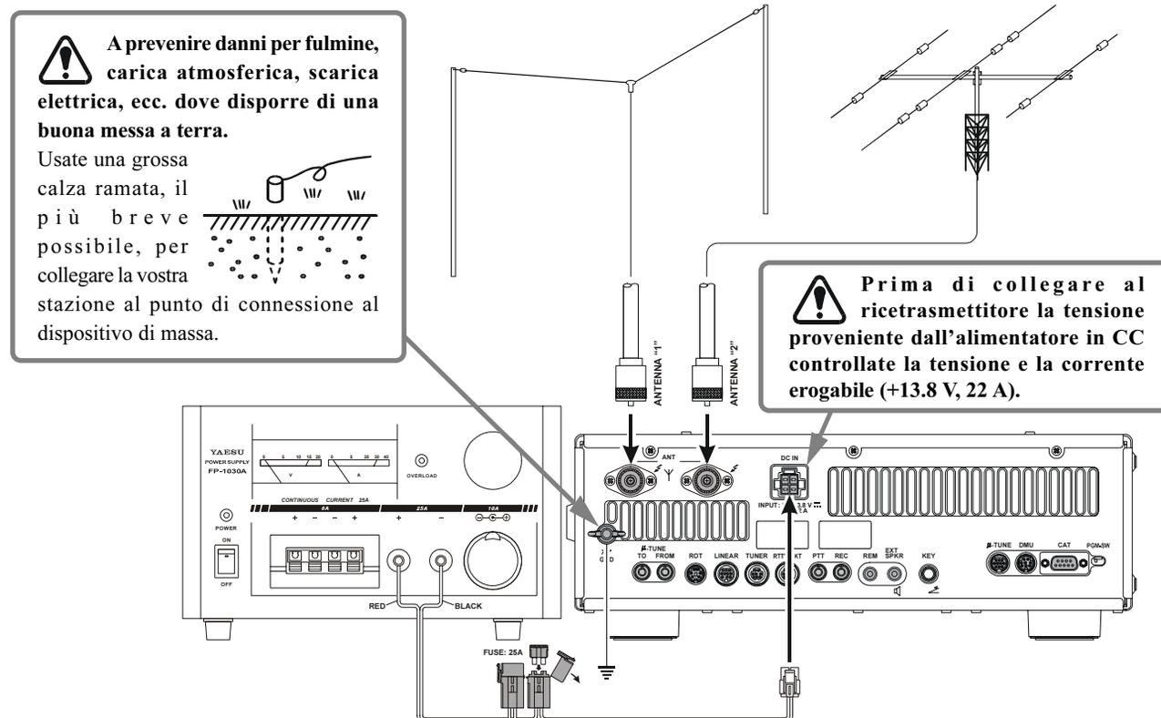
Vi raccomandiamo d'usare l'alimentatore dedicato **FP-1030A**, potete anche usare alimentatori stabilizzati commerciali purché con tensione d'uscita a 13.8 Vcc, in grado di erogare 22 A.
