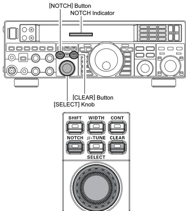
Le prestazioni del filtro Notch sono rappresentate in fig. (A), l'effetto della rotazione della manopola **[SELECT(NOTCH)]** è evidente. Nella fig. (B) si vede come il filtro, centrato su una interferenza ruotando la manopola **[SELECT(NOTCH)]**, possa sopprimerla.
