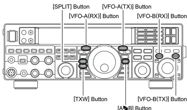
Durante il funzionamento a frequenze separate i registri del VFO-A sono usati per la ricezione, quelli del VFO-B per la trasmissione. Se premete ancora una volta **[SPLIT]** terminate il modo a frequenze separate.
