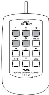
5. Per spostare il cursore usate i tasti [◀] e [▶] del FH-2, invece agite su [▲] e [▼] per scegliere la lettera / numero che volete immettere nella posizione. Nel caso del secondo esempio soprariportato "}" designa la posizione dove apparirà la numerazione progressiva Contest.
