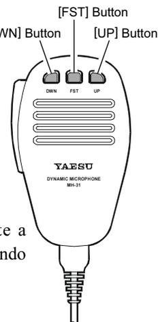
Questi applicano lo stesso passo della manopola di sintonia principale, premendo il tasto **[FST]** posto sul microfono il passo incrementa di 10 volte, analogamente a quanto avviene con l'identico comando posto sul pannello frontale.
