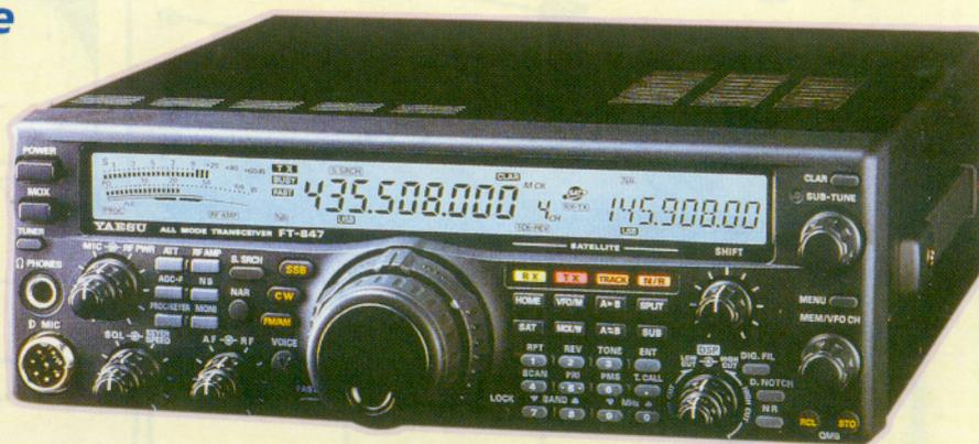
Le YAESU FT-847 regroupe en réalité quatre transceivers. L'ensemble des bandes décimétriques (au nombre de 9), les bandes VHF 50 et 144 MHz ainsi que la bande UHF 432 MHz sont couvertes !
