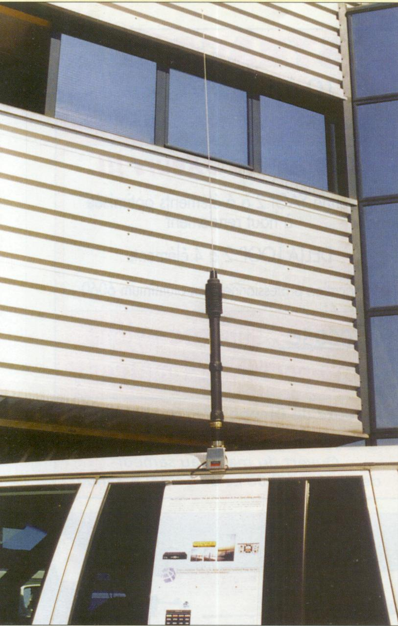
L'antenne ATAS-100 est particulièrement dédiée au FT-847. Elle fonctionne dans la gamme 7 à 440 MHz.
