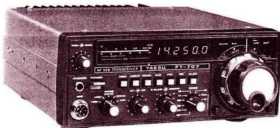
El FT-707 es un transceptor completamente de estado sólido para las bandas HF de aficionados . Cubre desde 80 hasta 10 metros, incluyendo las nuevas bandas de 12, 17 y 30 metros; y está diseñado para operar en SSB, CW y AM. La potencia es de 240 vatios PEP en SSB/CW y 80 en AM.
