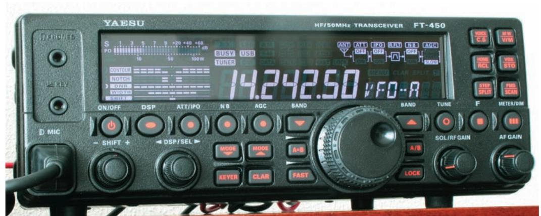
del DSP permite modificar la anchura del paso de banda IF en tres niveles (dos en frecuencia modulada). Este filtro es especialmente efectivo si se utiliza en conjunción con el Width, que tiene anchos de 1.8 KHz, 2.4 KHz y 3 KHz, en banda lateral; 500 Hz, 1.8 KHz y 2.4 KHz, en morse; 3 KHz, 6 KHz y 9 KHz, en AM, y 2.5 KHz y 5 KHz, en FM.
