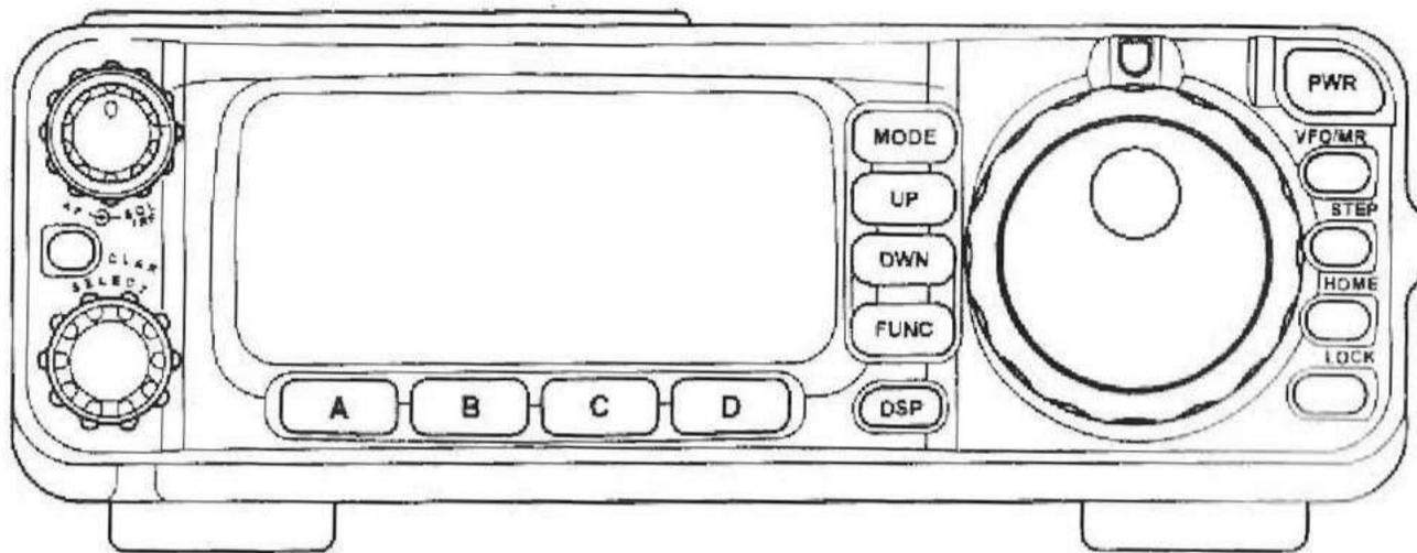
L'apparato FT-100D è un innovativo ricetrasmittitore multimodo che oltre a coprire tutte le nove bande amatoriali HF estende il funzionamento anche sulle bande VHF/UHF cioè le frequenze di 50, 144 e 430 MHz.
