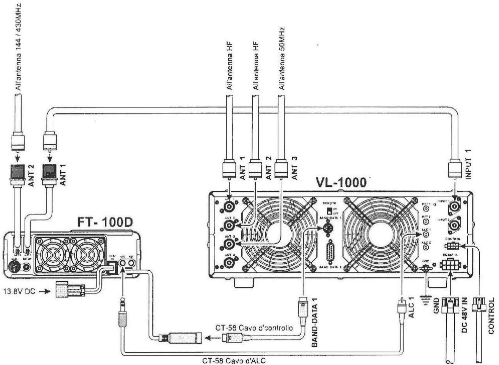
Quando operata con l'FT-100D connesso all'amplificatore allo stato solido VL-1000 da 1 kW modificate la connessione interna dell'FT-100D come qui sotto mostrato.
