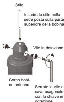
rimovibile o sul cofano bagagliaio utilizzate un modello che assicuri uno stabile e forte collegamento meccanico al corpo del veicolo (oltre che per dare una buona massa per reggere la forza resistente aerodinamica prodotta dall'antenna mentre viaggiate). Modelli idonei sono i Diamond TE5M e K400.
