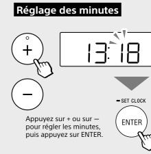
Remarques • Le mode de réglage de l'horloge est annulé après 65 secondes lorsqu'aucune opération n'est effectuée.
