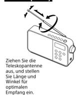
Ziehen Sie die Teleskopantenne aus, und stellen Sie die Länge und den Winkel für optimalen Empfang ein.
