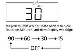
Mit jedem Drücken der Taste ändert sich die Dauer (in Minuten) auf dem Display wie folgt:
