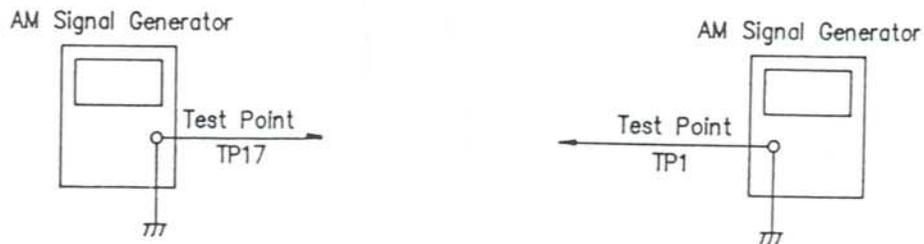
**(14) ALIGNMENT FOR HEAD AZIMUTH**
