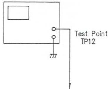
**(11) ALIGNMENT FOR 450kHz TRAP**
