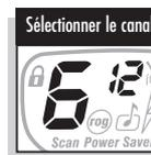
2. Appuyer sur la touche MODE jusqu'à ce que l'icône de double écoute et le numéro du canal clignotent sur l'afficheur.
