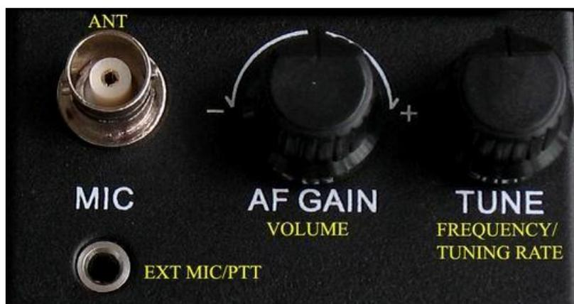
**BNC** - Toma de antena. Conecte una antena de 50ohm.
