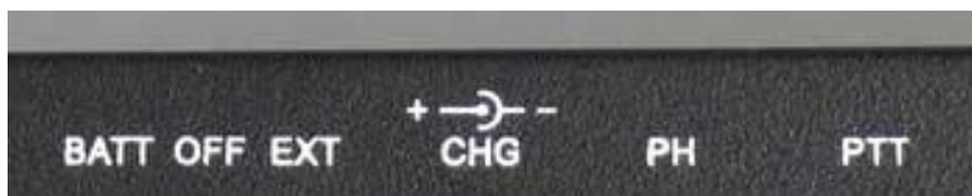
**CHG** – Toma para cargar la batería. La batería se cargará sin importar la posición en que esté el conmutador.
