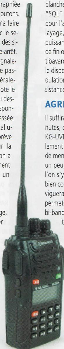
correspondances sont mentionnées en lettres blanches : "STEP" pour pas d'incrément, "SQL" pour l'ajustage du silencieux, "SAVE" pour l'arrêt automatique, "SCAN" pour le balayage, "TXP" pour le choix d'une des deux puissances d'émission, "ROGER" pour un bip de fin ou de début d'émission, "TOT" pour l'antibavard à durée personnalisable, "VOX" pour le dispositif mains libres, "W & N" pour la modulation large ou étroite, et "VOICE" pour l'assistance vocale.
