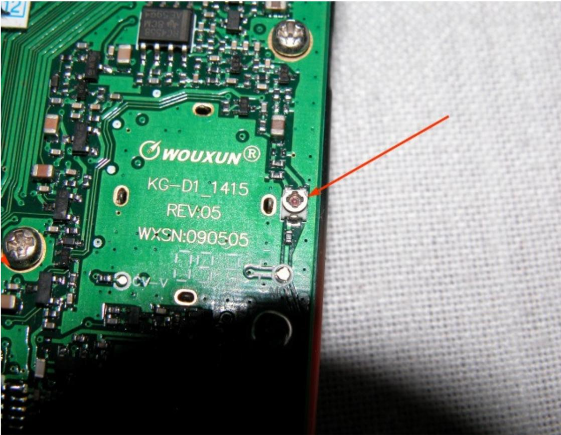
La regolazione puo' essere fatta ad orecchio utilizzando una altro apparato in Isofrequenza oppure mediante TestSet. Per incrementare la deviazione è sufficiente ruotare in senso antiorario il trimmer. Personalmente l'ho regolato ad orecchio facendogli compiere un giro di  $180^\circ$  antiorario e il risultato è stata una modulazione squillante e meno cupa rispetto all'originale. Mi riservo ovviamente appena possibile di dargli una misurata con il test set di laboratorio.
