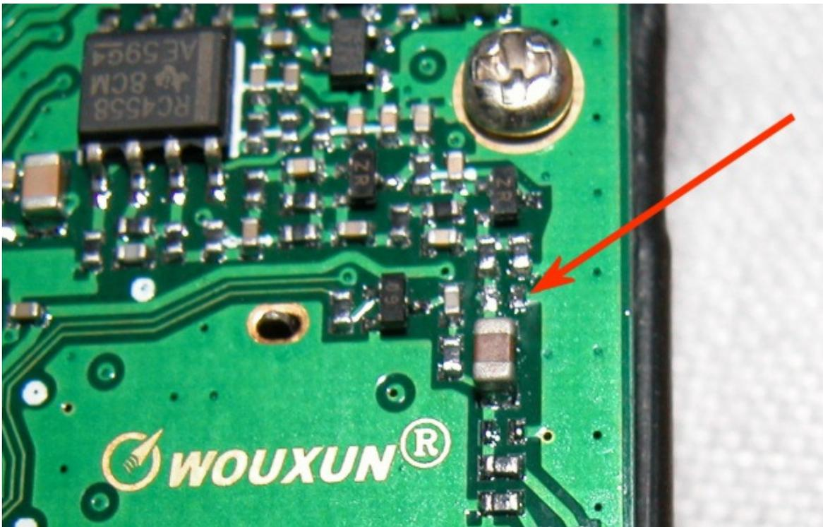
2° capacità di blocco del mic da rimuovere
