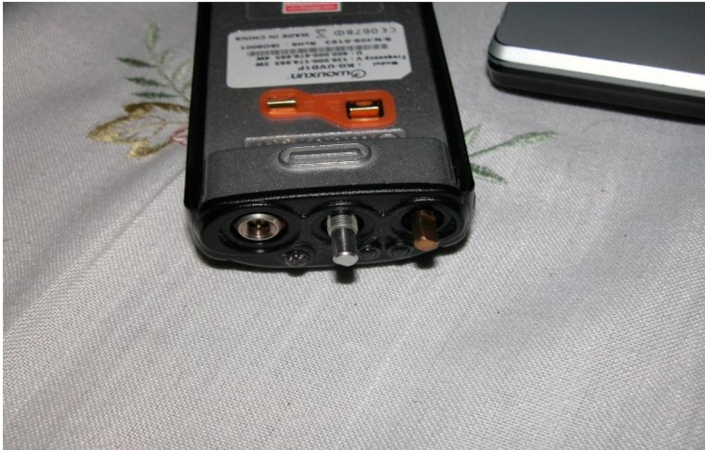
Per separare il corpo metallico della radio dal semiguscio in plastica è sufficiente fare leva sul fondo del corpo metallico con un cacciavite philips piatto in modo da portare in fuori il sudetto. **IMPORTANTE** : non separare le 2 parti di scatto e con forza in quando vi è una FLAT all'interno che potrebbe danneggiarsi, bisogna procedere con calma e una volta che la flat è accessibile, scollegarla, quindi terminare la separazione.
