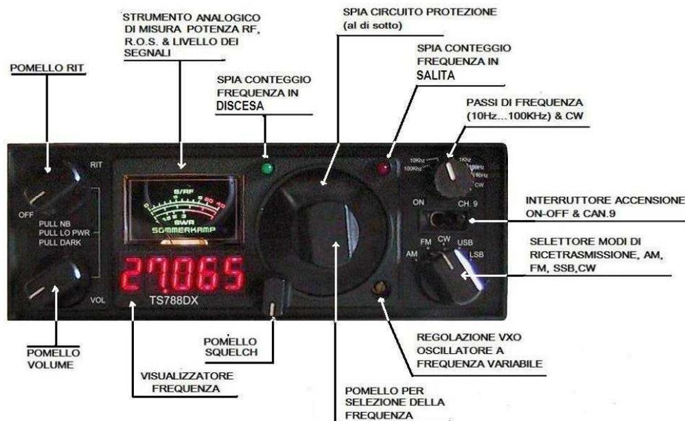
**COMMUTATORE ALIMENTAZIONE ON/ Off/ CH 9**
