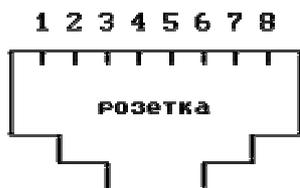
1,2,3,4 – TTL уровни (код диапазонов) для декодирования дешифратором K155ИД10 или аналогами. Управление внешними устройствами (УМ).
