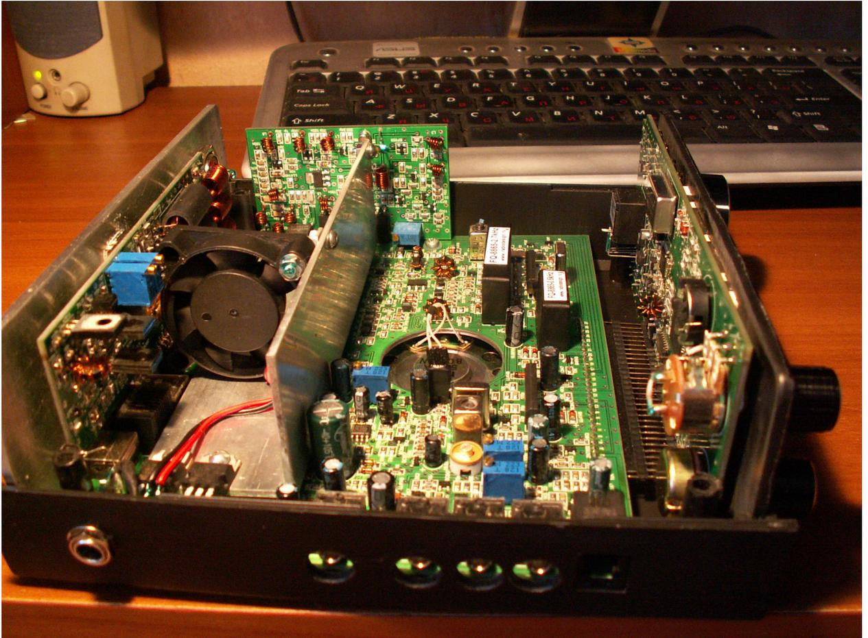
Для улучшения температурного режима трансивера рекомендуется, как один из вариантов, дополнительная установка вентилятора охлаждения. Данный вариант принудительного охлаждения является опцией и в базовом варианте может не реализовываться.
