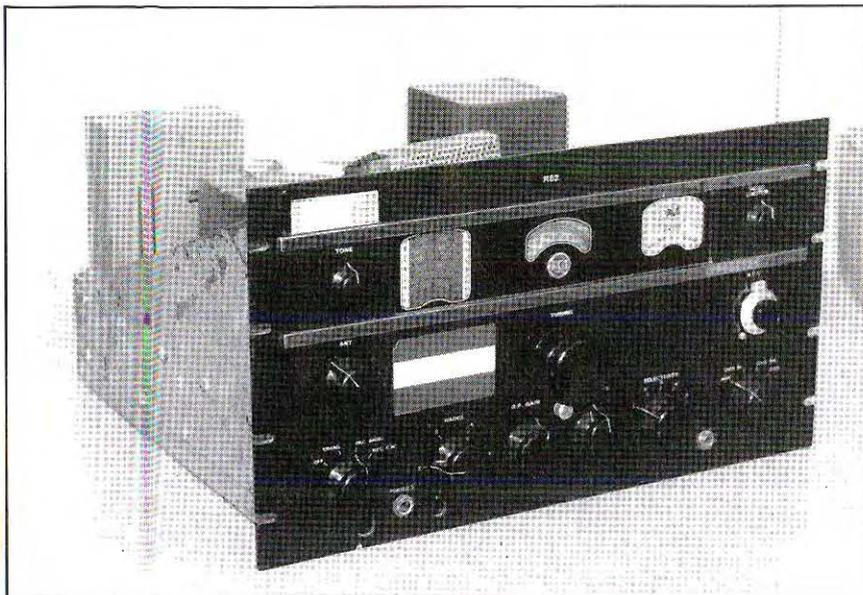
Versione standard AR-88D. (Per agevolare la regolazione del BFO, il potenziometro è comandato da una manopola demoltiplicata).
