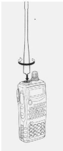
Avvitare l'antenna nel connettore SMA sulla parte superiore del ricetrasmittitore tenendola per la base ed avvitandola in senso orario.
