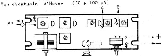
3) - Il ricevitore è ora pronto per il funzionamento; l'accensione si effettua agendo, in senso orario, sul perno del potenziometro di volume.
