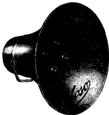
La tromba esponenziale mod. 2578 rappresenta il tipo di maggiore potenza costruito dalla nostra Casa. Essa riunisce quattro elementi ed è capace della notevole potenza di punta di 50 watt. E' costruita secondo il noto disegno a giglio che permette il massimo rendimento con un ingombro ridotto. Il materiale impiegato, la struttura meccanica curata e precisa, il rendimento e le curve di responso delle unità montate, fanno di questo modello un esemplare che non ha eguale sul mercato.
