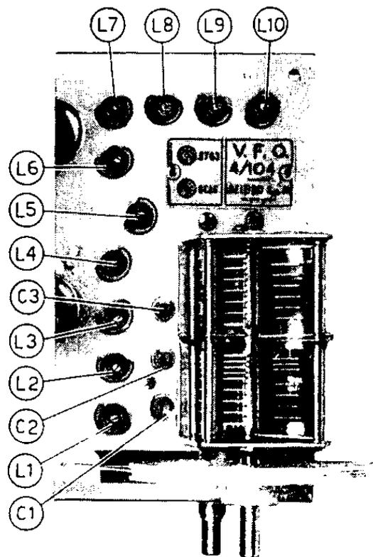
Fig. 1 — Posizione dei «trimmers» e delle induttanze regolabili, per l'allineamento del VFO.
