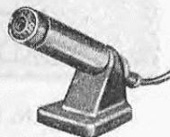
**M 69 - Microfono dinamico direzionale. Alta impedenza.** Risposta  $80 \div 14.000$  Hz. Consente l'attacco diretto con l'amplificatore a valvole (entrata alta impedenza; vedi trasmettitore G 4/223). Con schermo antisoffio. Necessita di cavo di collegamento N. 387. Peso netto circa gr 125.
