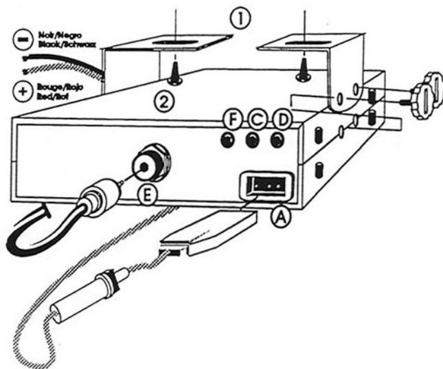
d) Utilisez pour le montage le berceau (1) livré avec l'appareil, fixez-le solidement à l'aide des vis autotaraudeuses (2) fournies (diamètre de perçage 3,2 mm). Prenez garde de ne pas endommager le système électrique du véhicule lors du perçage.
