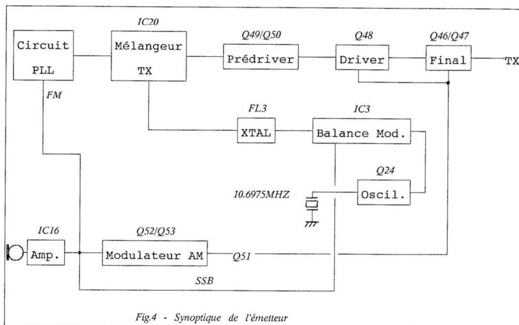
Fig.4 - Synoptique de l'émetteur
