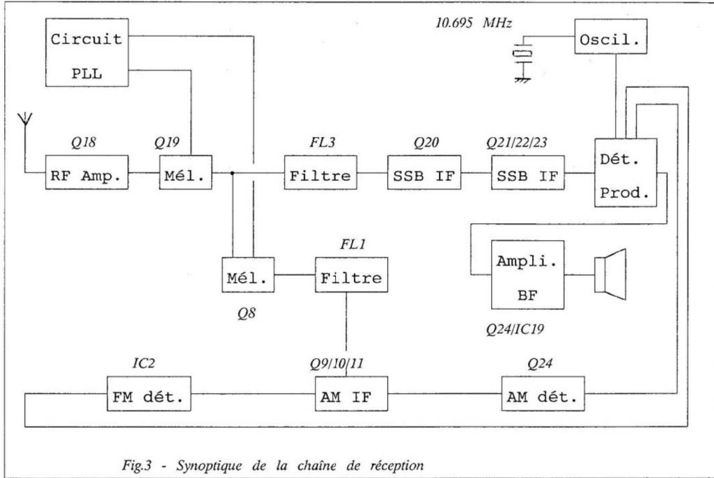
Fig.3 - Synoptique de la chaîne de réception
