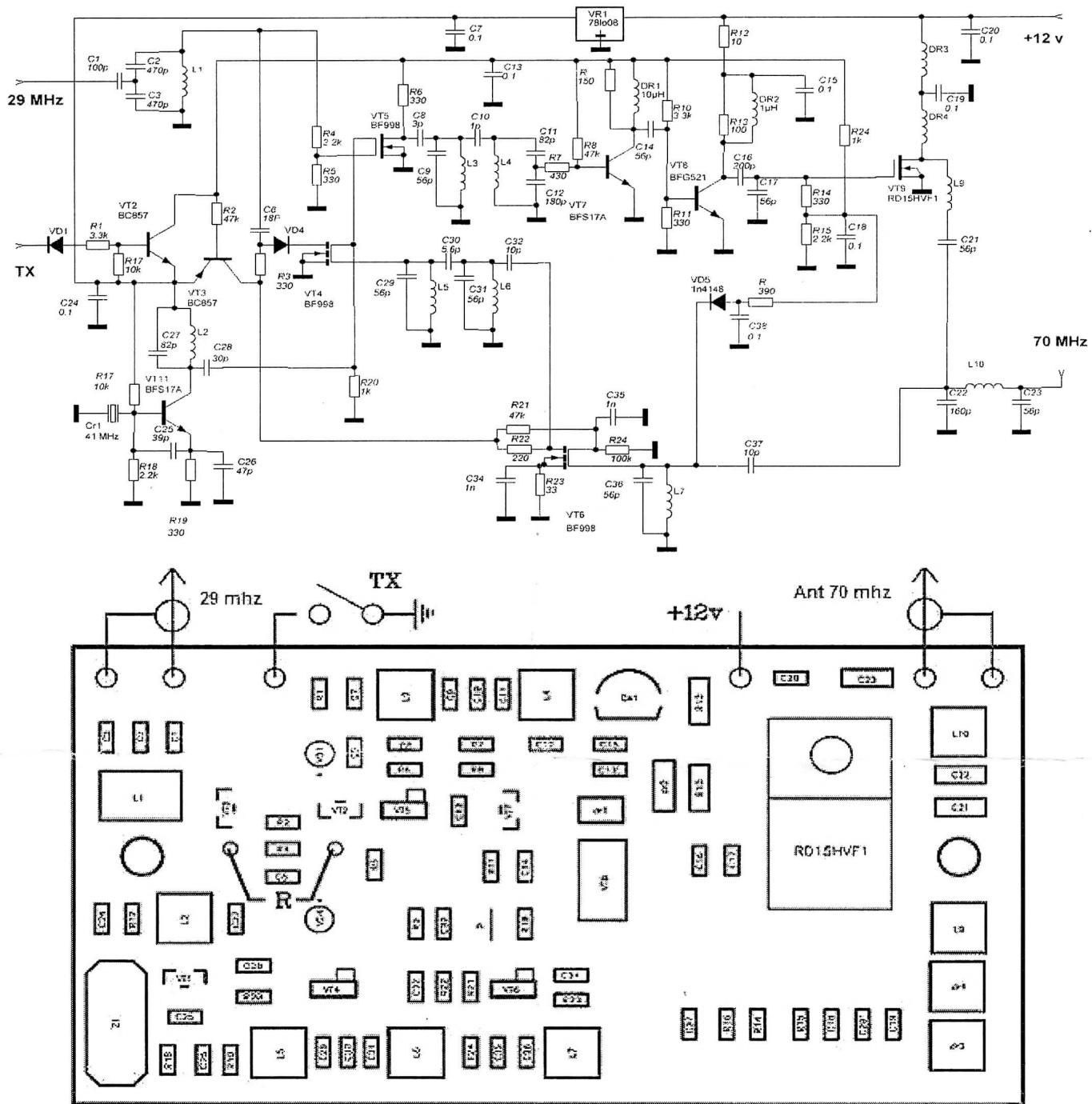
Подключение показано на рисунке. Минимальная входная мощность может быть 1 мвт при  $K=0$  и выше до сотен мвт. Определяется делителем  $R_{14}/R_6$ . При указанных номиналах входная мощность 0.15 вт. Если требуется изменить в любую сторону, то параллельно  $R_{14}$  имеются пятачки, где можно впаять резистор нужного номинала.
