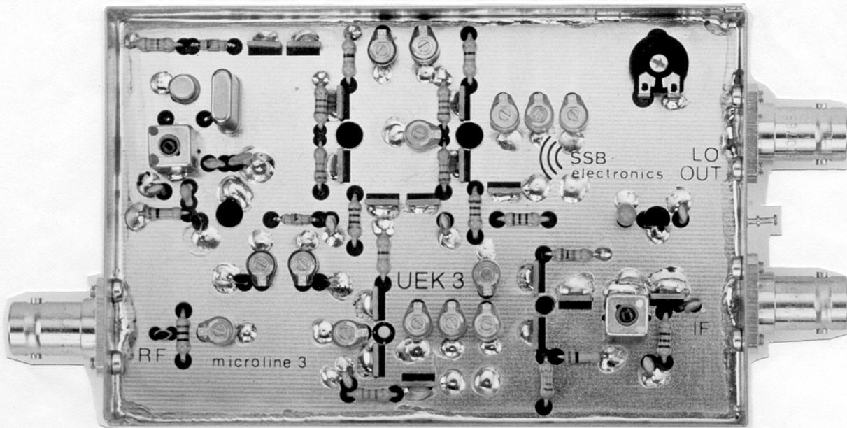
Dieser neu entwickelte Konverter-Baustein aus der Serie " microline 3 " beinhaltet eine Injektions-Frequenzaufbereitung zur Versorgung eines externen Sendemischers und zur Ansteuerung des eingebauten GaAs-Fet-Empfangsmischers.
