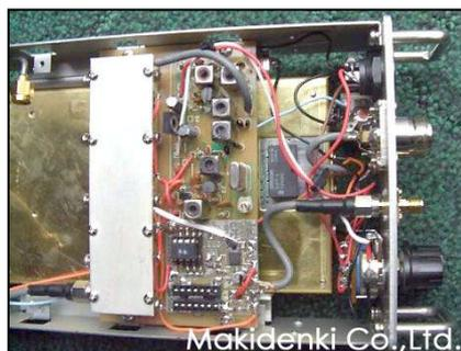
1100MHz 台の引き出し方法です・・・ケースには既に孔は開いていますので、細めの同軸ケーブルの先端を約13mmぐらいむき出して、先端を仕切り板の上の方に半田付けして・・・引き出しリンクです！
