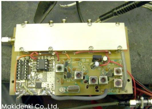
左の写真は、24GHz 用局発ユニットに PLL 基板ユニットをセットした状態です。
