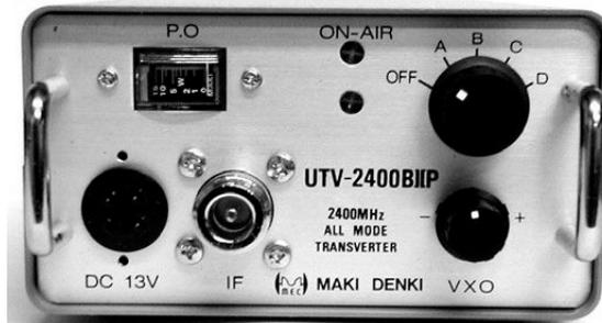
1200MHz,430MHz 市販トランスバーターを親機にして、2400MHz バンドへ簡単にQSY-UPできます。
