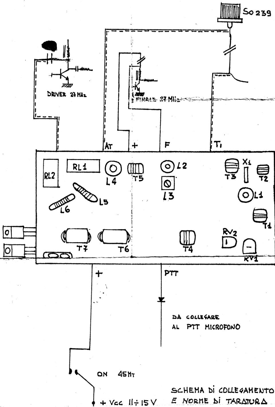
Eseguiti i collegamenti come da schema allegato, per la taratura del circuito portare il trimmer RV 1 al centro corsa, mandare in trasmissione e controllare su un oscilloscopio la forma d'onda. Aumentare il trimmer RV 1 fino a che la forma d'onda non inizi a distorgersi.
