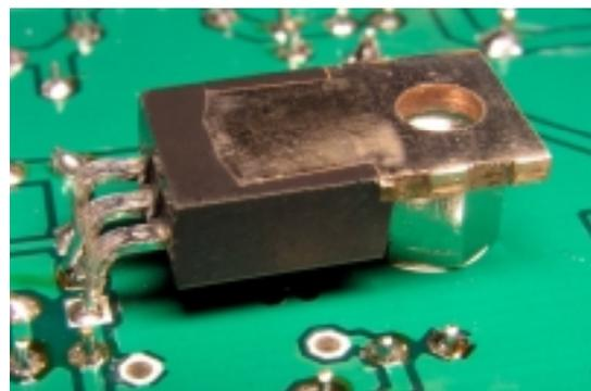
dem Gewinde des Stehbolzens liegt. Die Beinchen lötet man am besten von der Bauteilseite der Platine an. Der Kühlflansch schaut nun von der Platine weg und erlaubt das Anschrauben eines Kühlkörpers. Damit dieser einen zweiten Befestigungspunkt hat, wird der (lange) **6-mm**-Stehbolzen am anderen Platinenende in der entsprechenden Bohrung angeschraubt.
