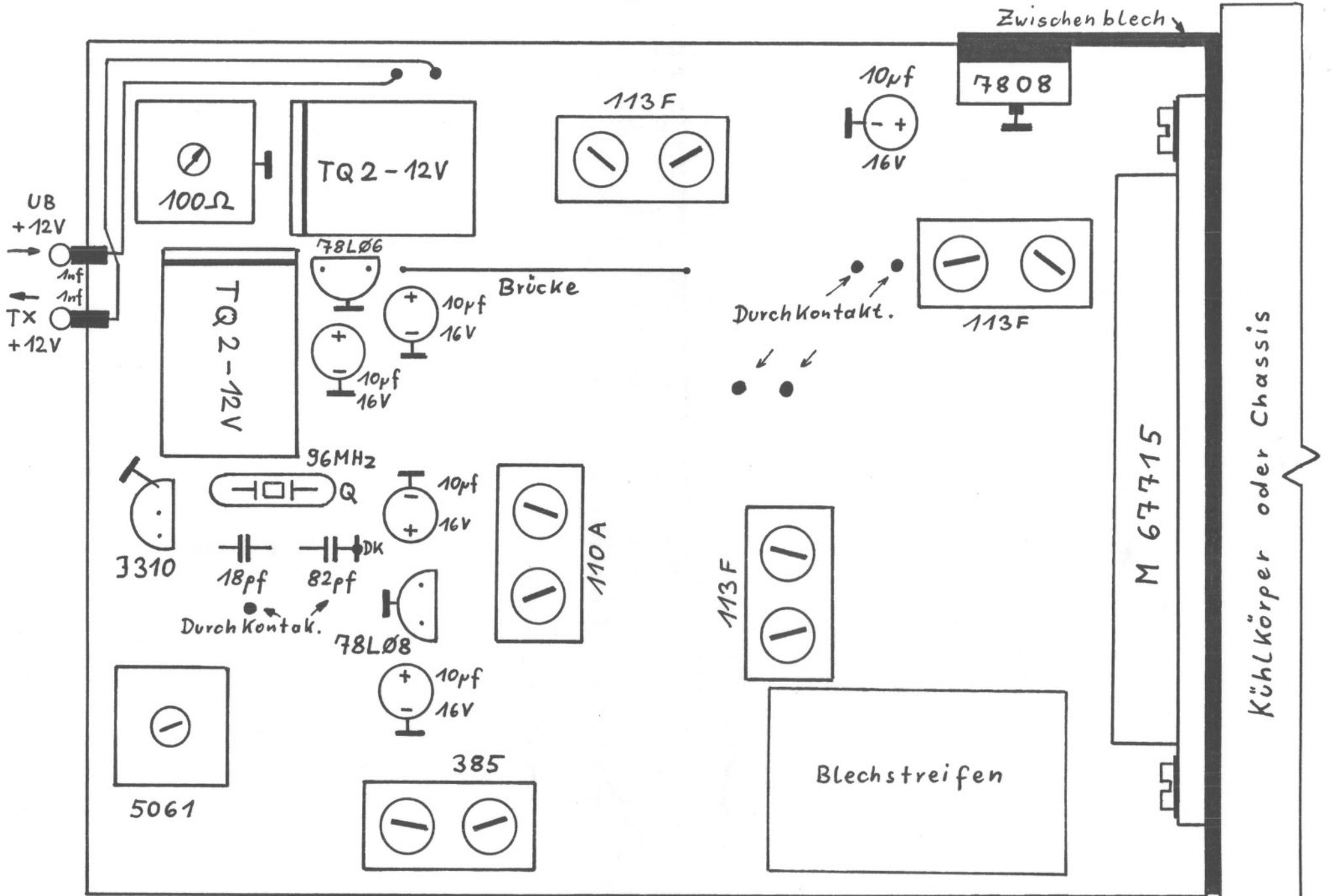
Blechstreifen und Filterbechergehäuse gut mit Masse verlöten!
