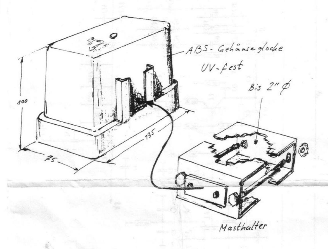
Der Zusammenbau der Masthalterung für die DRESSLER-Vorverstärker der EVV-Serie geschieht gemäß obiger Skizze. Die Einbauschritte können wie folgt kurz beschrieber wer in :
