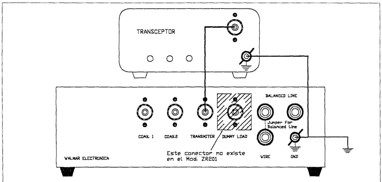
3) **Ant.1 Ant.2** Conecte sus antenas por medio de un conector macho PL-259 a conector 1 y/o 2 siempre utilizando coaxial de 50/52  $\Omega$ .
