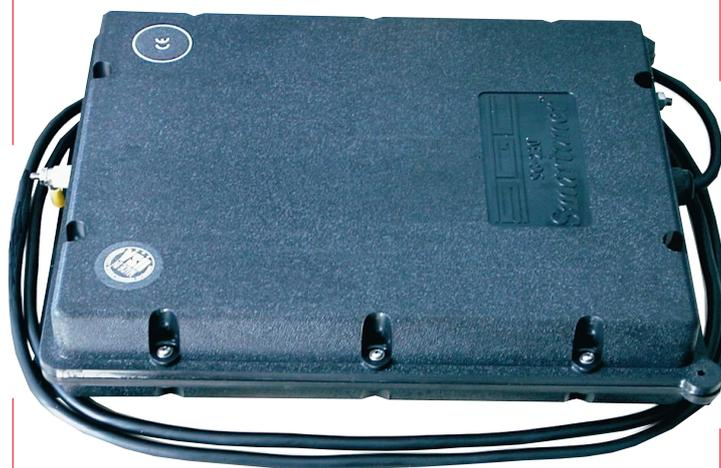
un cordon coaxial équipé d'une PL259. L'alimentation sera prélevée sur une batterie ou toute source régulée (10 à 15 V) capable de délivrer un ampère. En option, il est possible de l'alimenter sous 24 V. Le coupleur admet 200 W entre 1,6 et 30 MHz. Il lui faut une dizaine de watts pour se régler (on peut réduire cette exigence à 3 W). A l'accord, le ROS ne dépasse
