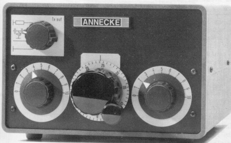
Bild 3) Universal-Transmatch Typ 2o2 mit Schalter, auf Dummyload, Netzwerk, Durchgang, Masse.
