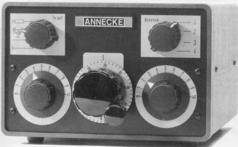
Bild 4) Universal-Transmatch Typ 2o2 mit 2 Schaltern Funktionen siehe Bild 2 und 3.
