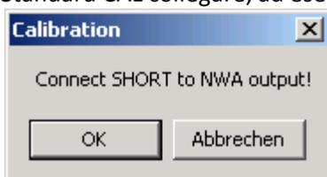
Ora, collegare gli standard di calibrazione, che vi si chiede, e premere **ok** quando fatto. Output è sinonimo di Porta TX e Input per porta RX. Se si preme "annulla", non verrà effettuata nessuna misura. È possibile ripetere la calibrazione di ogni misurazione in qualsiasi momento. È possibile calibrare in qualsiasi ordine che vi pare. Dopo una scansione di calibrazione riuscita, la luce rossa corrispondente diventa verde, il che indica, che sono disponibili dei dati di calibrazione validi:
