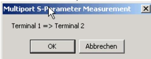
Dopo che la misurazione Forward (S11, S21) è terminata, è necessario girare manualmente il DUT e confermare nuovamente con il tasto OK, che si è pronti per la misurazione Reverse.
