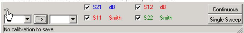
**Nota:** Senza l'uso di un **set di test per parametri-S**, impostare la direzione nel menu determina soltanto in quale spazio/dati, vengono memorizzati i dati che verranno misurati. Le funzioni della porta Tx e porta Rx rimangono invariate. Questo significa, **il VNWA2.x non può modificare automaticamente la direzione del flusso del segnale.**
