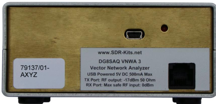
Il VNWA3 combina le funzionalità del VNWA2 con l'interfaccia USB, entrambi montate in una singola scheda da 100x60mm
