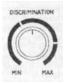
Girando la manopola discrimination si possono selezionare diversi tipi di segnali. Questa caratteristica vi consente di scegliere tra metalli ferrosi e metalli non ferrosi inoltre discrimina le dimensioni dello stesso tipo di metallo.
