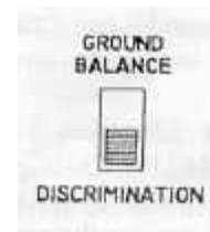
La modalità "ground balance" permette di ritrovare qualsiasi tipo di metallo senza discriminazione, eliminando però l' effetto "mineralization reaction", questa modalità è utilizzata all' inizio di una ricerca.
