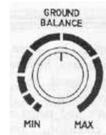
Mettere al massimo la manopola, dopo aver regolato il volume del "critical sound", alzare la bobina di ricerca fino a sentire il livello audio aumentare. Ora mettere al minimo la manopola quindi operando come sopra il volume diminuisce. Questo esperimento dimostra che il volume cambia girando la manopola Ground da una parte all' altra della scala, quindi ci deve essere un punto della scala in cui il volume resta stabile, questo punto rappresenta il punto ottimale di "Ground balance point".
