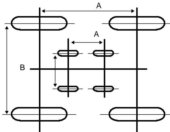
Der Antennengewinn kann erhöht werden, indem mehrere gleiche Antennen vertikal, horizontal oder in beide Richtungen gestockt werden. Theoretisch ergibt jede Verdoppelung einen Mehrgewinn von 3 dB, wenn der optimale Stockungsabstand eingehalten wird. Unglücklicherweise entstehen beim Stocken jedoch Nebenzipfel im Diagramm. Es muß daher ein Kompromiß zwischen minimalen Nebenzipfeln und maximalem Gewinn gefunden werden.
