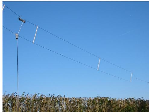
L'antenne **ITA TACTICAL** est un dipôle replié sur une résistance de charge non inductive, du type T2FD. Elle fonctionne de 1 à 30 MHz mais surtout, de par sa taille, pour un rendement optimal sur les bandes basses, inférieures à 10 MHz.
