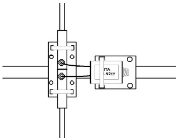
Balun éleveur d'impédance pour dipôle d'antenne Yagi, permet de passer de 25 à 50 ohms. A utiliser avec un kit de fixation 50/50 pour un montage aisé.
