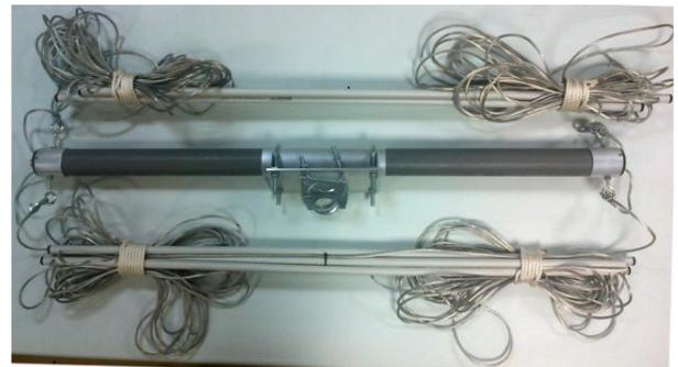
Elle est livrée avec une plaque et des colliers permettant son installation en haut d'un mat mais aussi de cordages aux extrémités pour pouvoir être tendue à l'horizontale ou en "sloper". Elle fonctionne sans réglage et possède un connecteur SO-239 (N à la demande). La résistance de charge et le balun sont intégrés dans le tube central ("attaque" classique en 50 ohms). Longueur : 32 m x largeur : 1 m, puissance : 1000 watts PEP. Utilisation en émission avec coupleur recommandée.
