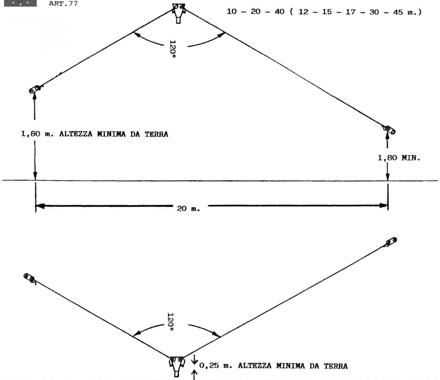
Questo dipolo non necessita taratura e si può installare nei due modi indicati nei disegni.
