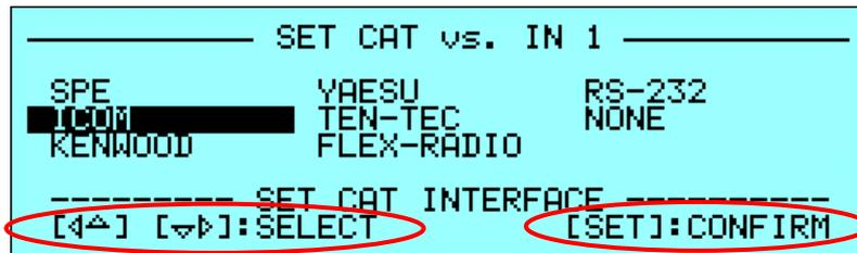
Le choix du modèle d'interface supporté sera présentée (ex. les transceiver ICOM disposent de deux types d'interface la CI-V et le VOLTAGE\_BAND): le choix voulu sera validé au moyen de la touche **[SET]**:
