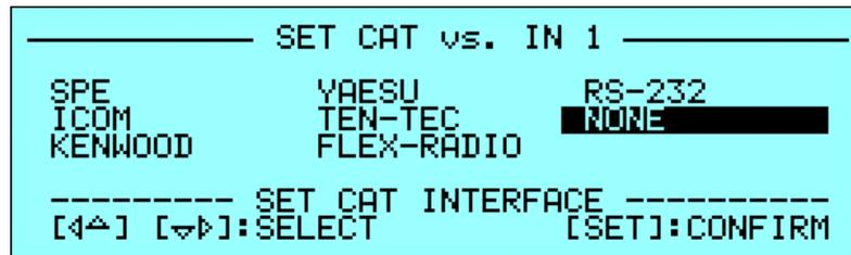
Pour effectuer une nouvelle position il faut sélectionner une des voies proposées en agissant avec les touches flèche ([<▲] [▼▶]) et valider au moyen de la touche **[SET]**:
