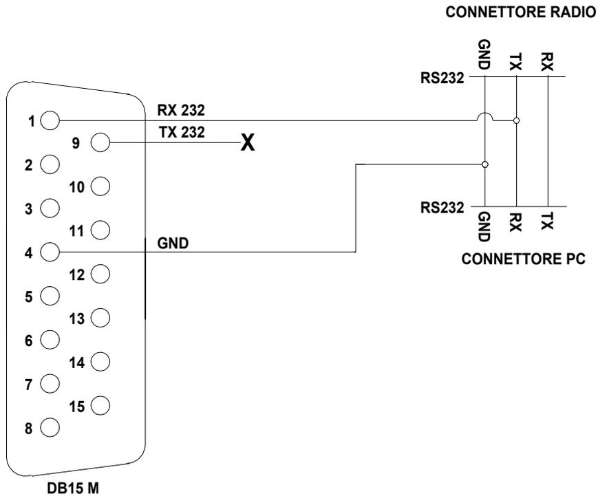
Questo tipo di collegamento è comune per Kenwood, Yaesu, TEN-TEC, FlexRadio ed ELECRAFT, i collegamenti lato connettore DB-15 del lineare rimangono gli stessi. Nel lato opposto del cavo è necessario collegare solo GND e RX 232 in parallelo al cavo PC / Radio.
