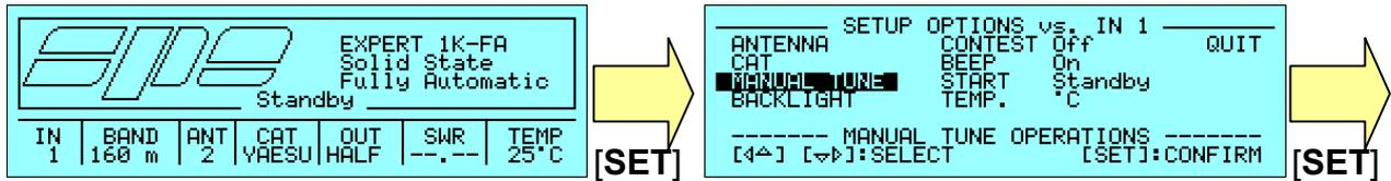
Questa schermata serve per permettere eventuali variazioni dei valori L-C dell'accordatore automatico; questa operazione può rendersi necessaria se l'utilizzatore non riesce ad ottenere una soddisfacente condizione di accordo con la procedura automatica o se, semplicemente, vuole applicare delle variazioni manuali alla configurazione attuale.
