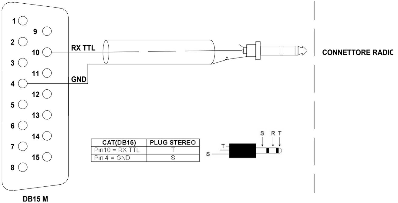
Questa interfaccia è standard per tutti i modelli Icom equipaggiati di CAT, il cavo termina sempre con un Plug da 3,5 mm.
