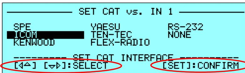
Verrà presentata la scelta del modello di interfaccia supportata (es. i ricetrasmittitori ICOM dispongono di due tipi di interfaccia la CI-V e la VOLTAGE\_BAND): la scelta voluta andrà convalidata mediante la pressione del tasto **[SET]**:
