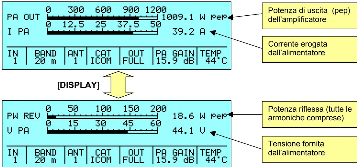
Le indicazioni dei valori di potenza d'uscita, potenza inversa, corrente e tensione sono riprodotte, oltre che in formato numerico, anche per mezzo di "barre di livello" rappresentate graficamente e dotate di un apposito meccanismo di mantenimento del picco massimo (circa 1 secondo) utile per poter meglio apprezzare le variazioni repentine delle grandezze misurate.
