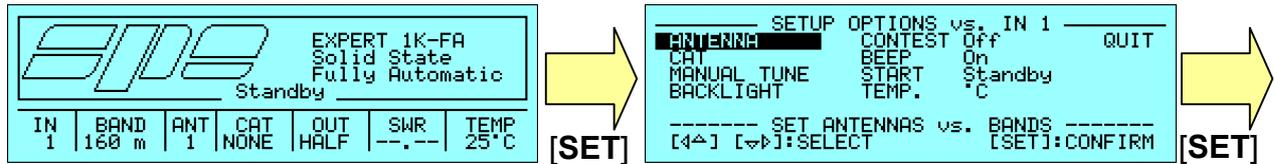
Il Menù Antenna permette l'impostazione delle antenne da abbinare ad ogni banda radioamatoriale per ognuno dei due ingressi; le scelte possibili sono:
