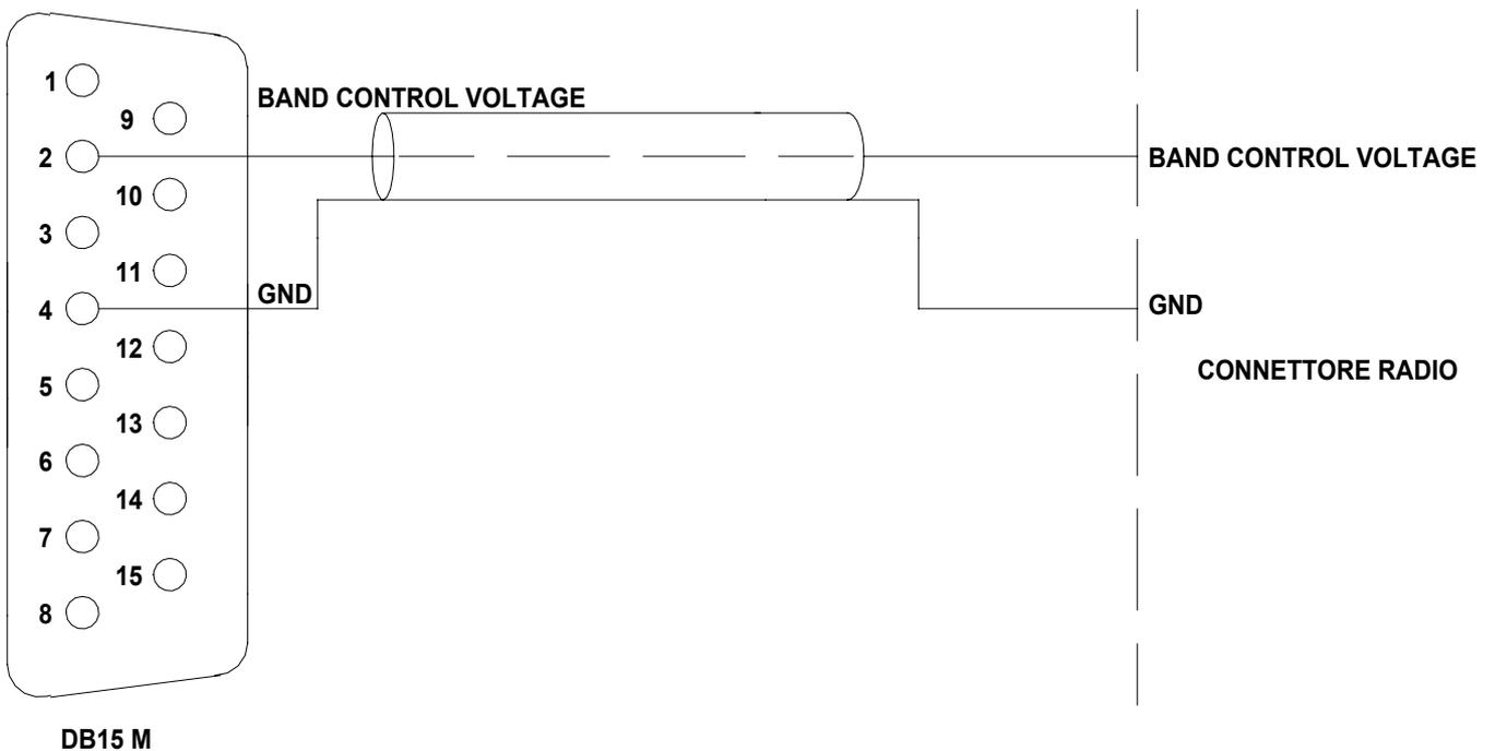
Questa interfaccia è standard per tutti i modelli Icom non equipaggiati di CAT, la variazione di una tensione determina il cambiamento di banda.
