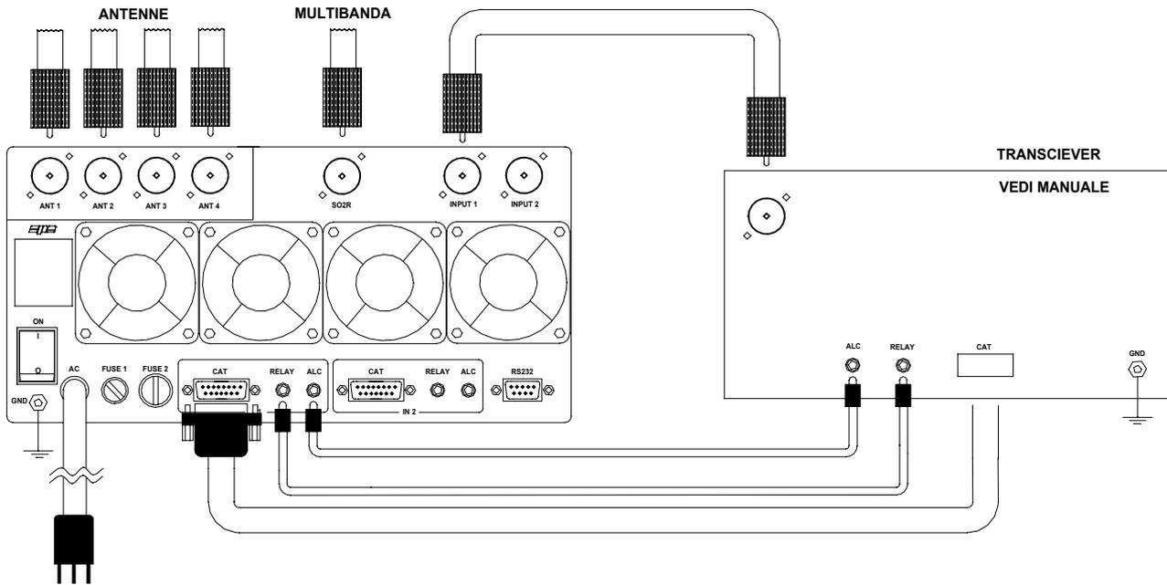
Vengono riportati i collegamenti con un solo transceiver, se si vuole collegare anche il secondo basta ripetere gli stessi collegamenti utilizzando il port "IN 2".
