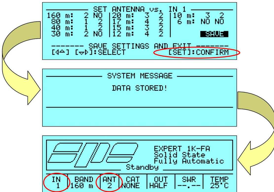
La casella **ANT** della **Barra di Stato** riporta, in questo esempio, il nuovo valore di antenna (**ANT 2**) impostato per la banda selezionata dei 160 m.
