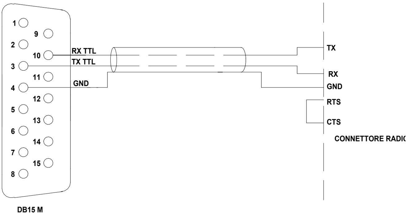
Il connettore radio viene descritto nello specifico manuale. Verificare se è necessario o meno il ponticello RTS-CTS.
