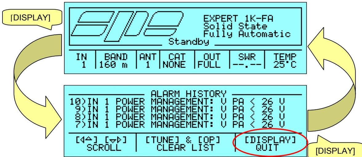
La schermata dello **Storico Allarmi** può visualizzare al massimo quattro messaggi per volta per cui, per poter esaminare eventuali messaggi “fuori vista”, vanno utilizzati i tasti freccia ([◀▲] [▼▶]) per ottenere lo scorrimento del testo.
