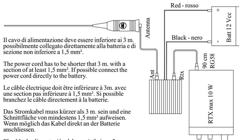
Il cavo di alimentazione deve essere inferiore ai 3 m. possibilmente collegato direttamente alla batteria e di sezione non inferiore a 1,5 mm<sup>2</sup>.
