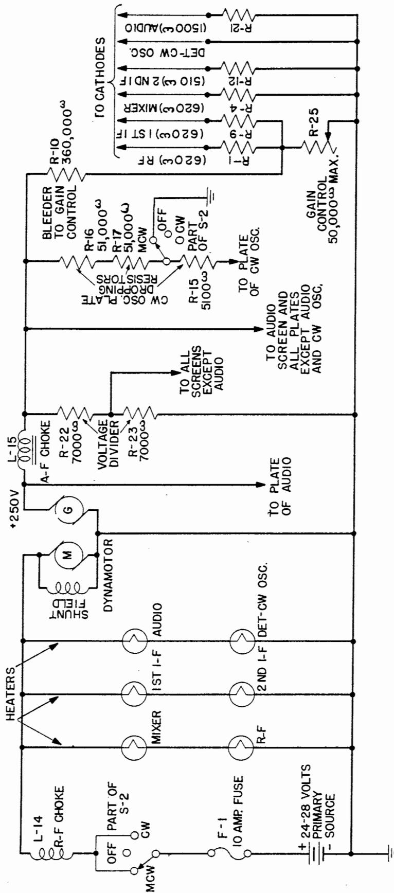
FIGURE 5—FUNCTIONAL DIAGRAM OF THE D-C CIRCUITS OF A TYPICAL RADIO RECEIVER
