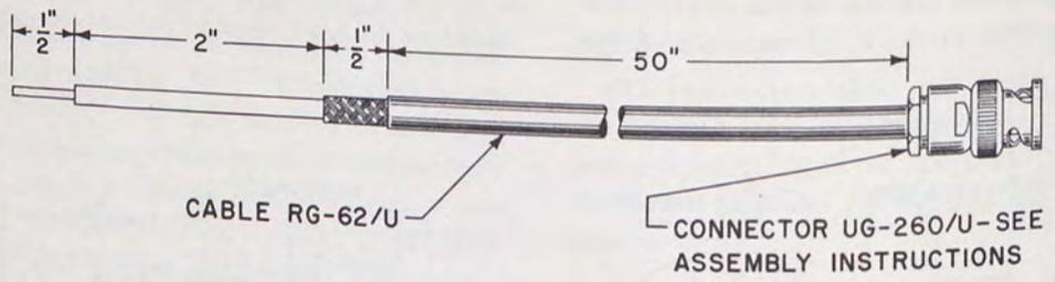
CABLE FOR DUMMY ANTENNA
