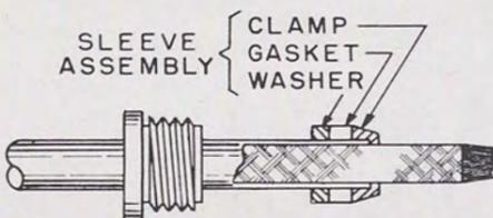
5. SLIDE SLEEVE OVER TAPERED BRAID TO FIT TIGHT AGAINST JACKET. BE SURE INNER SHOULDER OF SLEEVE FITS SQUARELY AGAINST END OF CABLE JACKET.
