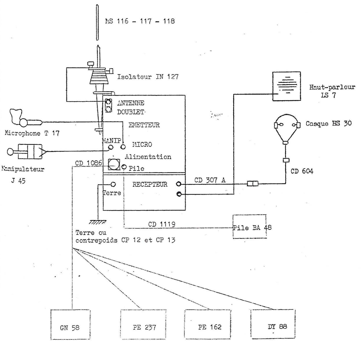
FIGURE 2 Schéma de branchement du poste radio AN/GRC-9 avec différents modes d'alimentation
