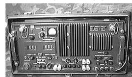
Gamma operativa da 69,975 a 107,975 MHz. Sintonia e antenne separate RX e TX. Larghezza di banda 25 kHz FM. Potenza resa in antenna circa 25W. Ascolto in altoparlante entrocontenuto. Possibilità di inserire microtelefono esterno. Alimentazione a 220Vca e 24 Vcc. Gli apparati vengono venduti per il solo scopo collezionistico, pertanto non vengono provati. Su richiesta vengono forniti i manuali operativi e di servizio. € 350 ottimo stato
