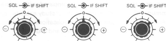
**Ruotare in senso (-) per eliminare l'interferenza causata dal segnale (B)**
