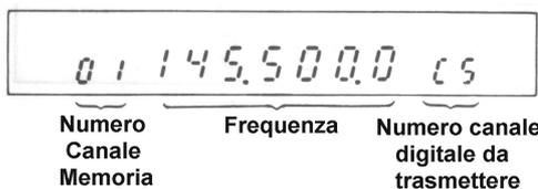
La frequenza potrà essere determinata con la manopola di sintonia ed il canale codificato da trasmettere, verrà scelto agendo sul comando CS.
